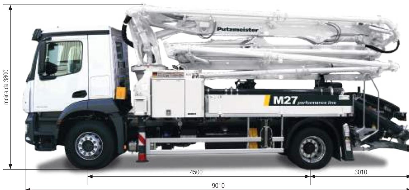
Nota : Exécution standard. Dimensions et poids variables suivant châssis, pompe et équipement. Dimensions en mm, exemple du modèle MB Arocs 1835. Les illustrations comportent des équipements optionnels.
